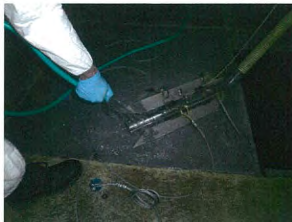
Manutenção regular da sonda espectrofotométrica S:CAN
